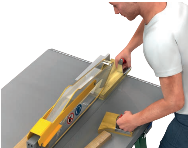
Seitenstoßholz: Linke Hand zieht den Sägeabschnitt aus dem Sägeblattbereich.
