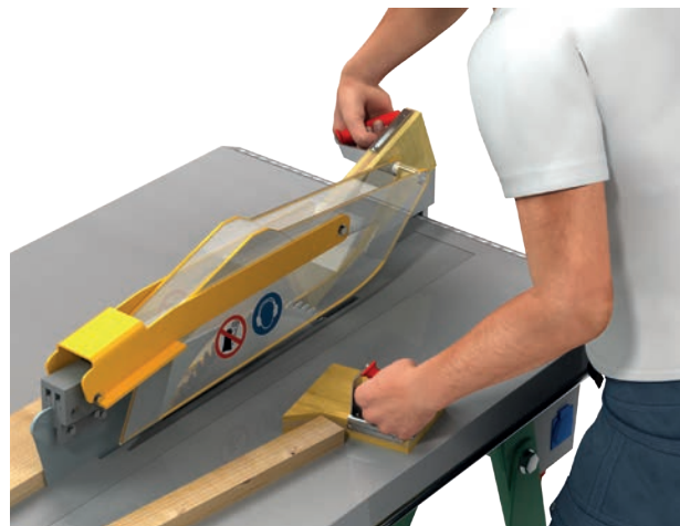
Längsstoßholz: Aufgestelltes Stoßholz schiebt das Werkstück aus dem Sägeblattbereich.
