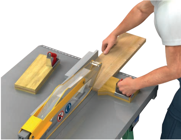
Seitenstoßholz: Linke Hand führt das Werkstück am Längsanschlag.
