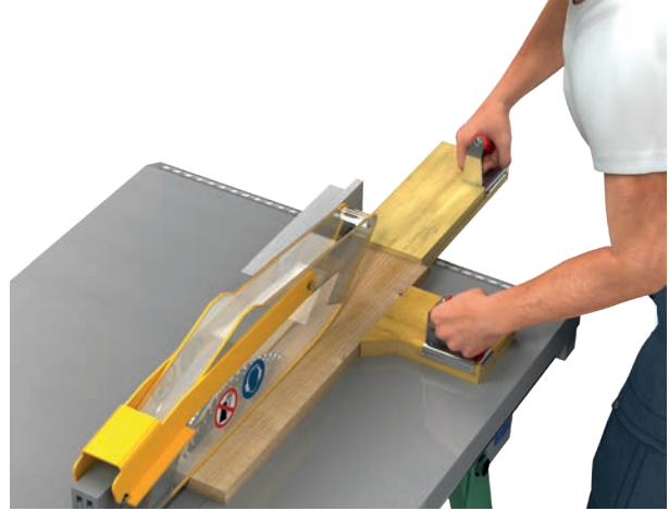
Längsstoßholz: Rechte Hand schiebt das Werkstück durch die Kreissäge.
