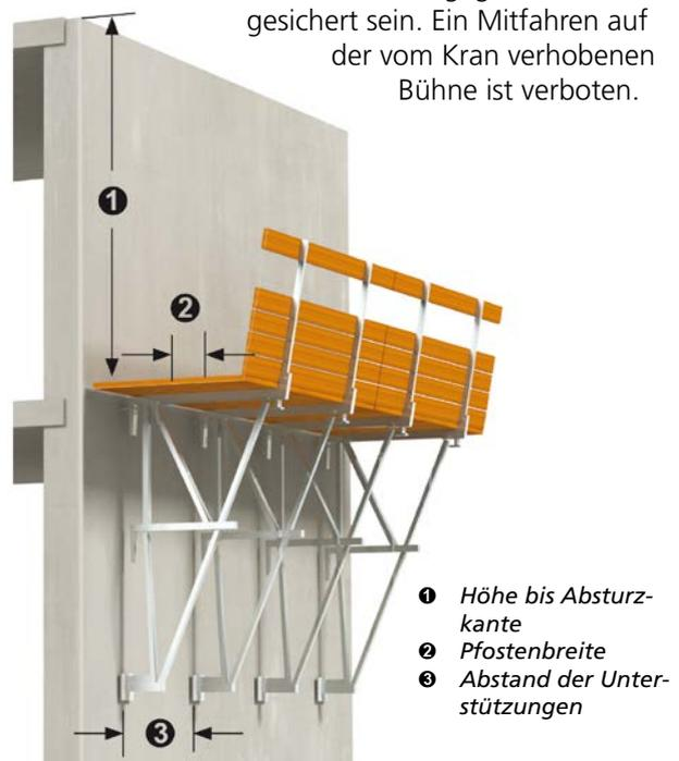
Durch die Befestigung von Konsolgerüsten an tragfähigen Bauteilen muss ein unbeabsichtigtes Lösen der Konsolen ausgeschlossen werden
