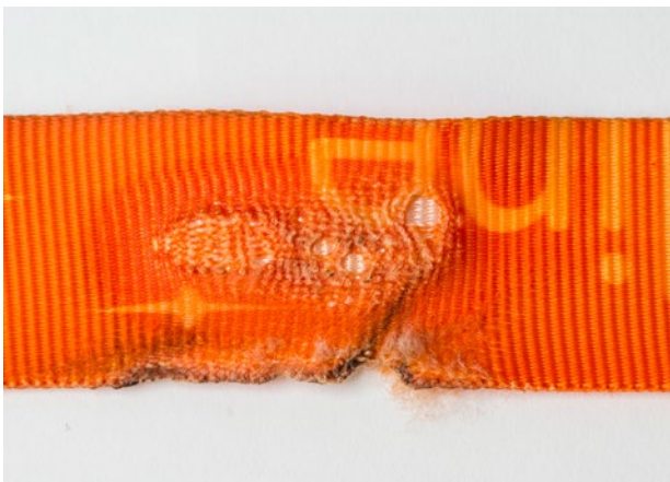
Innenliegendes Webmaterial aufgrund mechanischer Beschädigung des Gurtbandes sichtbar.
