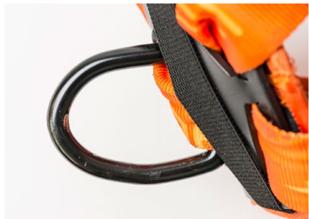
Verformte Halteöse nach Sturzbelastung oder missbräuchlicher Verwendung
