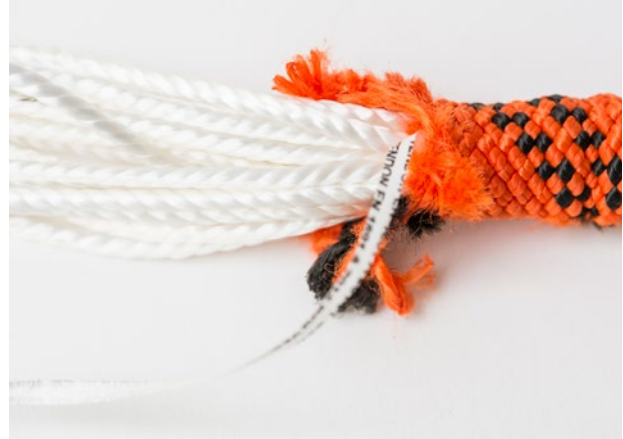
Beschädigung des Mantelgewebes bei einem Kern-Mantel-Seil aufgrund mechanischer Einwirkung.
