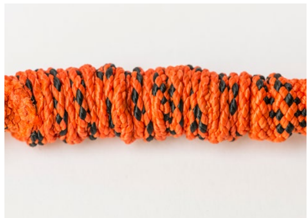
Stauchung des Mantels bei einem Kern-Mantel-Seil: Der außenliegende Seilmantel hat sich aufgrund einer dynamischen Belastung (bspw. Sturz) vom innenliegenden Seilkern gelöst.
