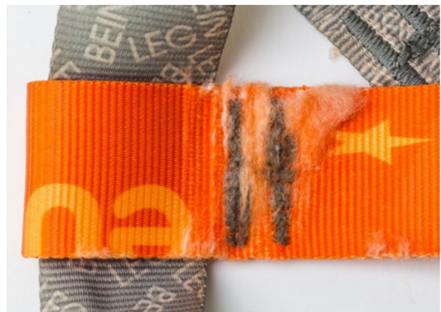
Nahtbild aufgrund mechanischer Abscheuerung nicht mehr eindeutig erkennbar.
