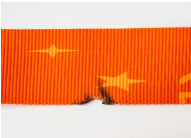
Anschmelzstelle auf einem Gurtband aufgrund thermischer Einwirkung.
