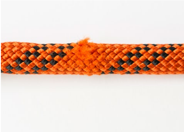
Abscheuerung bei einem Kern-Mantel-Seil.
