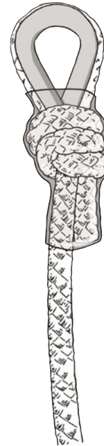
geflochtenes Seil mit Spierenstich u. Kausche: Es sind nur Kunst- stoffkauschen zulässig, die mit Schrumpfschlauch gesichert sind.
