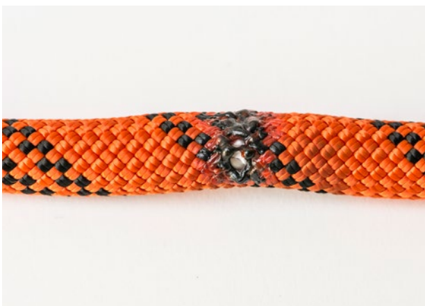
Anschmelzstelle auf einem Kern-Mantel-Seil aufgrund thermischer Einwirkung.
