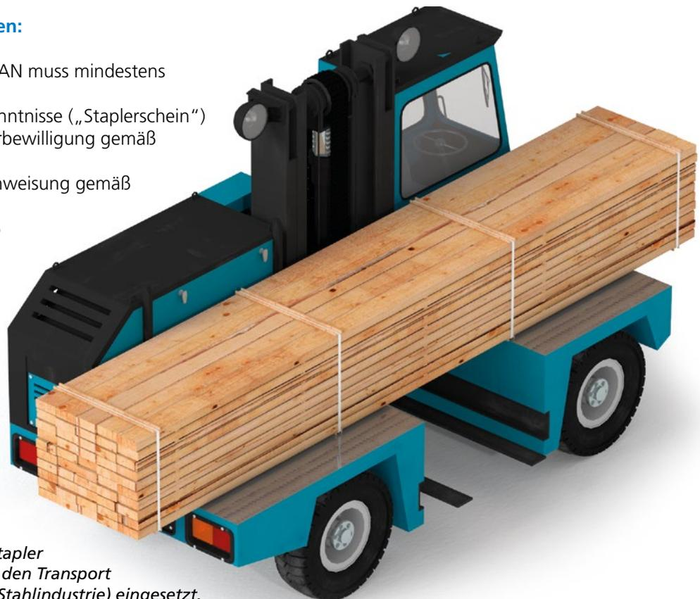
*Seiten- oder Quergabelstapler werden zum Beispiel für den Transport von Langgut (Holz- und Stahlindustrie) eingesetzt.*
