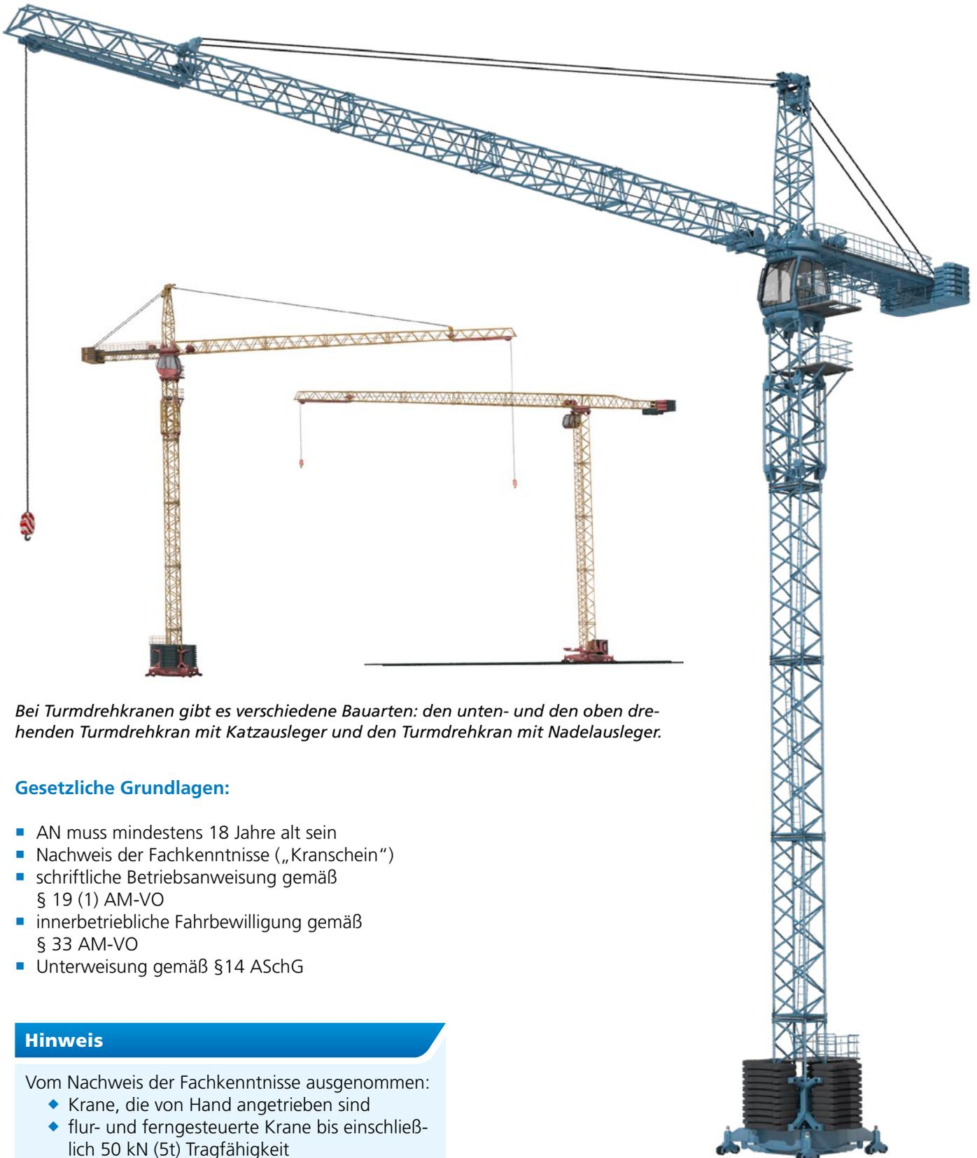
Bei Turmdrehkränen gibt es verschiedene Bauarten: den unten- und den oben drehenden Turmdrehkran mit Katzausleger und den Turmdrehkran mit Nadelausleger.
