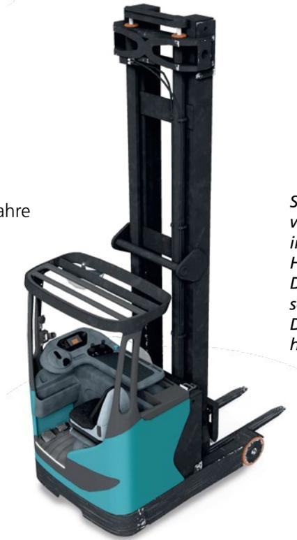
*Schubmaststapler werden üblicherweise in Hochregalen (große Hubhöhen) eingesetzt. Der Staplerfahrer sitzt seitlich zur Fahrrichtung. Der Hubmast lässt sich horizontal verschieben.*
