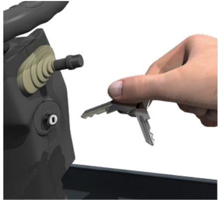
*Sicherung gegen unbefugte Inbetriebnahme durch Abziehen des Schlüssels*
